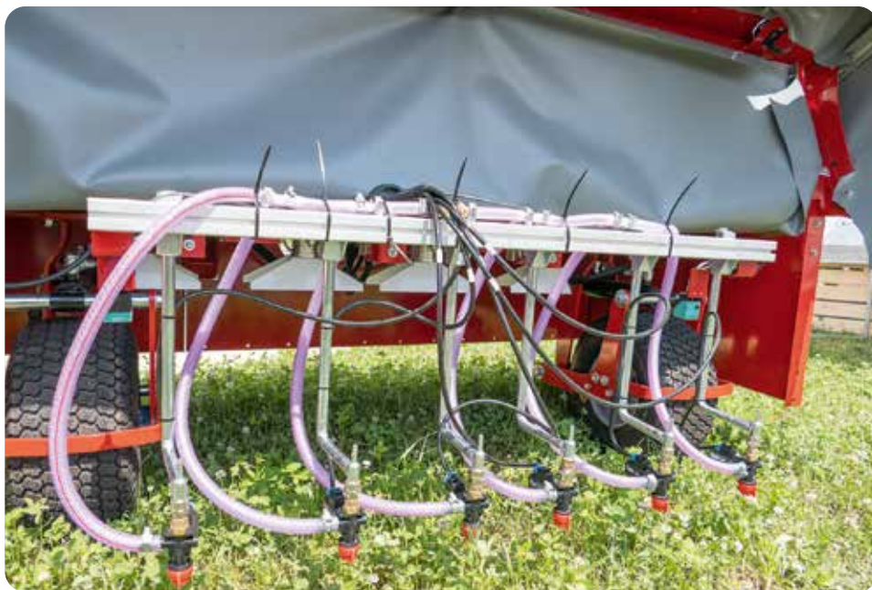
Aktueller Spot-Spraying-Prototyp von Steketee mit kameragesteuerter Spritzfunktion. Prototype actuel de spot-spraying de Steketee avec fonction de pulvérisation pilotée par caméras. EP
